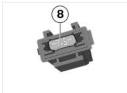
Sicherung 8 für Kühlerlüfter
